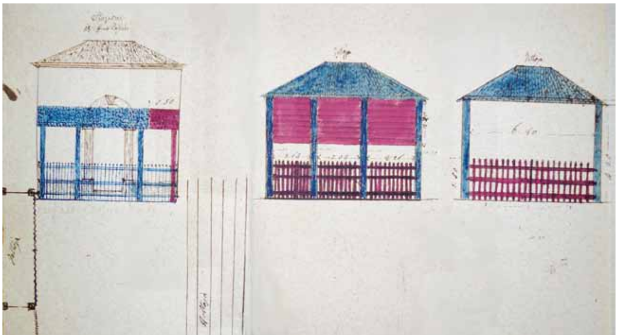
Stazione della strada ferrata di Coccaglio 1854. Veduta dell' I.R. Ufficio postale e progetto di una tettoia "riparo", con stecato a terra. A protezione sia di porte e finestre che delle operazioni di trasbordo.
